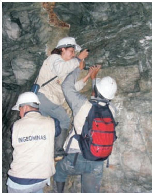
Toma de muestras de roca llevada a cabo durante el levantamiento geológico del túnel de La Línea.
