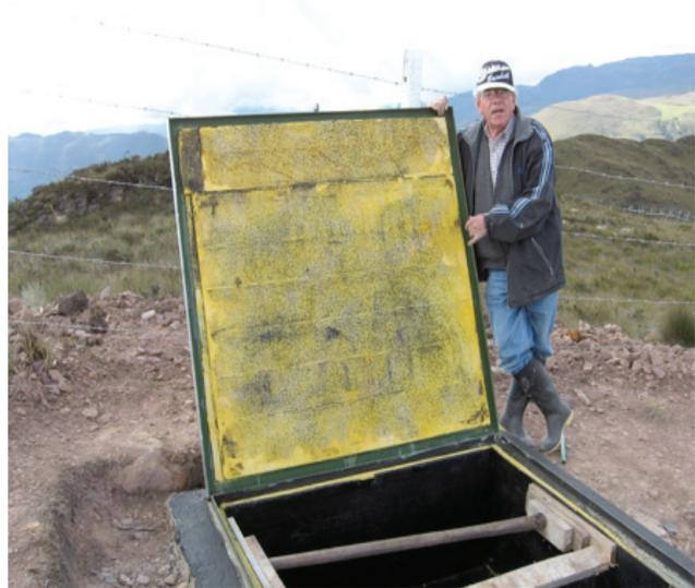
**Figura 4.** Detalles de un búnker típico para el sismómetro de una estación de banda ancha de la RSNC.
